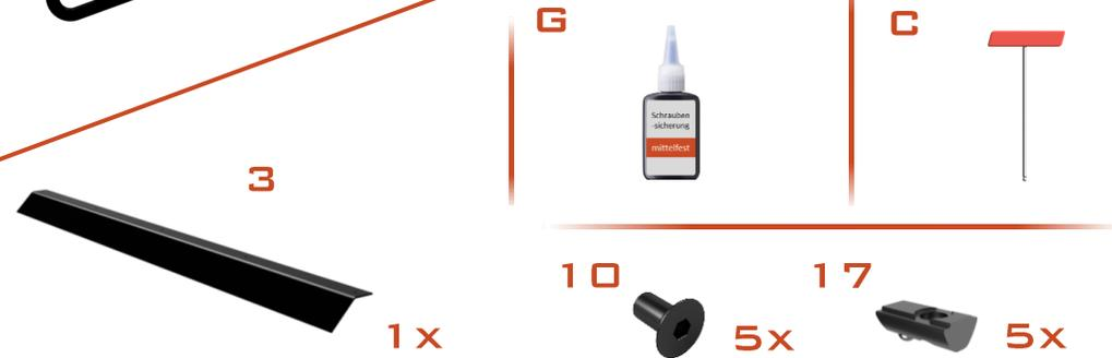
13.) DER WINDABWEISER WIRD VON UNTEN MIT DEN PROFILEN VERSCHRAUBT. FÜHREN SIE DAFÜR DIE NUTENSTEINE (17) AN DEN ENTSPRECHENDEN POSITIONEN IN DIE PROFILE EIN. DIE BEIDEN ÄUSSEREN NUTENSTEINE WERDEN IN DIE LÄNGSTRÄGER MONTIERT, DIE 3 MITTLEREN NUTENSTEINE IN DEN VORDEREN QUERTRÄGER
