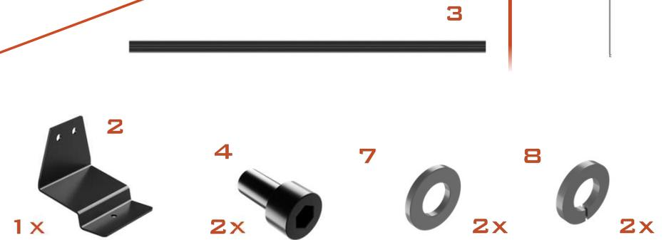
2.) SCHRAUBEN SIE DIE ZYLINDERKOPFSCHRAUBEN (4) IN DIE STIRNSEITIGEN GEWINDE DER QUERSTREBEN (3). ACHTEN SIE DABEI AUF DIE KORREKTE REIHENFOLGE VON FEDERRING (8) UND UNTERLEGSCHIEBE (7).
